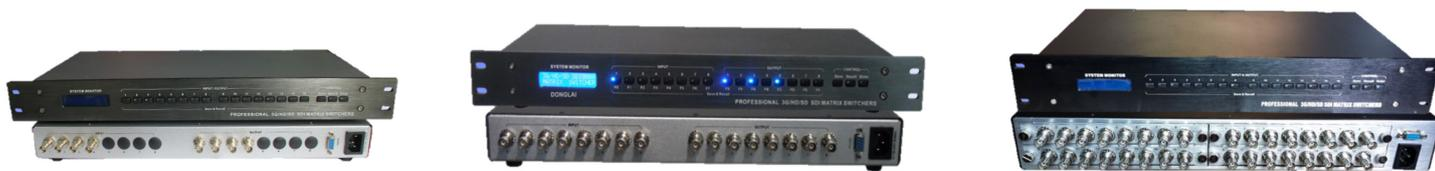
3G/HD/SD SDI 數字高清矩陣切換器是專為數位高清視訊訊號的顯示切換而設計的高性能智慧矩陣開關設備，用於將各路視頻輸入信號切換到視頻輸出通道中的任一通道上。採用 BNC 介面，產品可訂製 4、8、16 路的 SDI 視訊訊號輸入輸出，具有強大的記憶存儲功能和掉電記憶功能，保證資料不會因突然掉電而丟失，擁有自動均衡功能和時脈重整功能保證信號的高品質傳輸，帶輸入前端精確自我調整補償，將最大的輸入距離延長至 140 米 ( 3G )、200 米 ( HD ) 和 400 米 ( SD )。矩陣具有 LCD 液晶顯示、按鍵快速切換，狀態查詢、快速場景存儲及調用 ( 可存儲及調用 16 個不同的場景 )、支援輸入信號狀態監測，具備 RS232 ( 標配 )、乙太網控制埠 ( 選配 )。支援全數位技術傳輸高達 2.97Gbps 的多速率 SDI 信號。採用 19 英寸標準上架主機殼設計，使用靈活方便。
